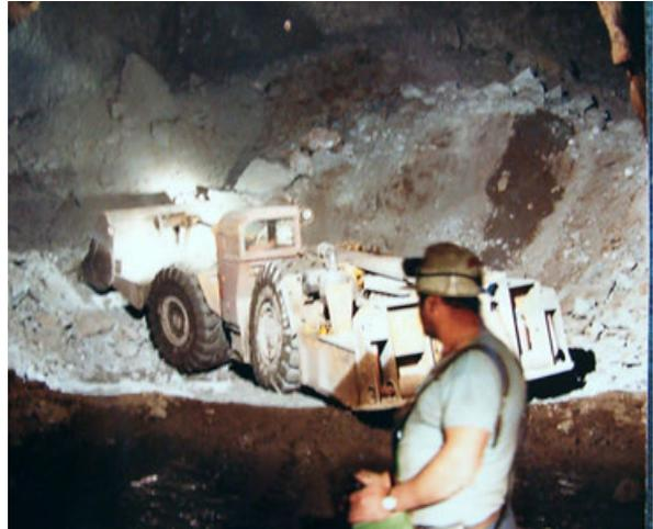
**Fig. 17** - Autopala diesel con benna da 4-5 m<sup>3</sup> radiocomandata da console portatile (Miniera di Campiano. Anni '80).
