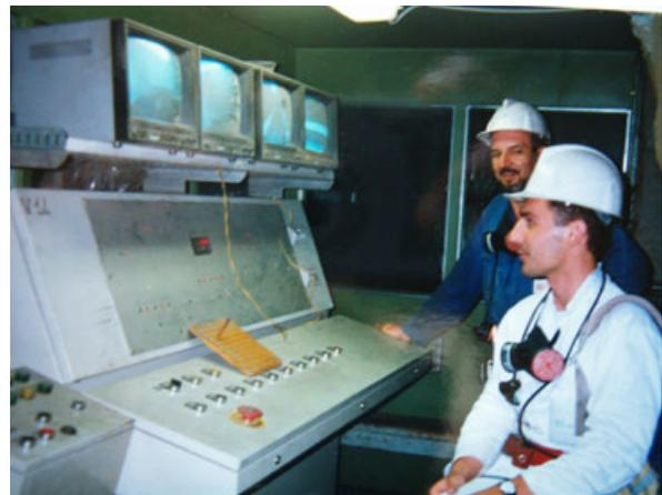
Fig. 27 - Miniera di Campiano: sala di controllo dell'impianto di frantumazione e caricamento dello "skip" (700 m al di sotto della superficie).
