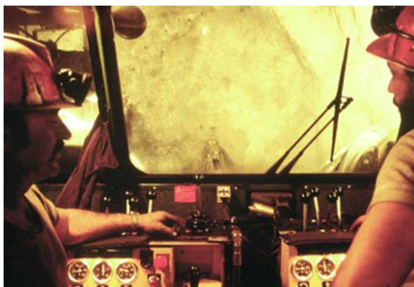
**Fig. 9** - Interno di un carro di perforazione elettroidraulico dotato cabina chiusa (insonorizzata, coibentata e climatizzata), Miniera di Campiano. Anni '90.
