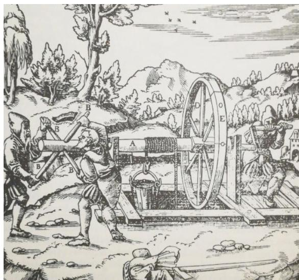
Fig. 19 - Pozzo di estrazione con argano a mano (da G. Agricola - De Re Metallica).
