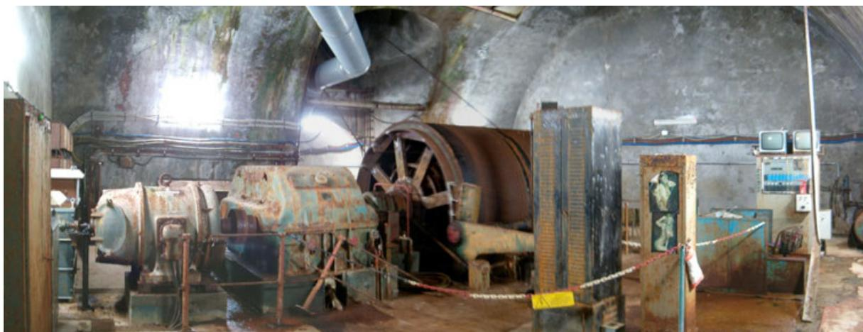
**Fig. 23** - Parco Tecnologico e Archeologico delle Colline Metallifere Grossetane. Miniera di Gavorrano: sala argano del pozzo Impero, situata al livello +240 s.l.m. (Foto dell'autore).
