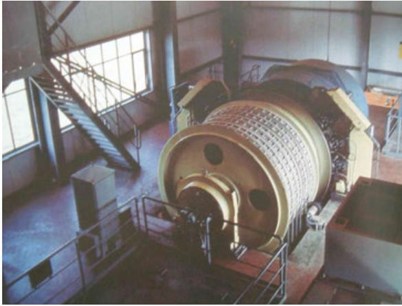
Fig. 24 - Miniera di Campiano. Sala argano del Pozzo 1. Uno dei due tamburi a puleggia "Koepe" polifune.
