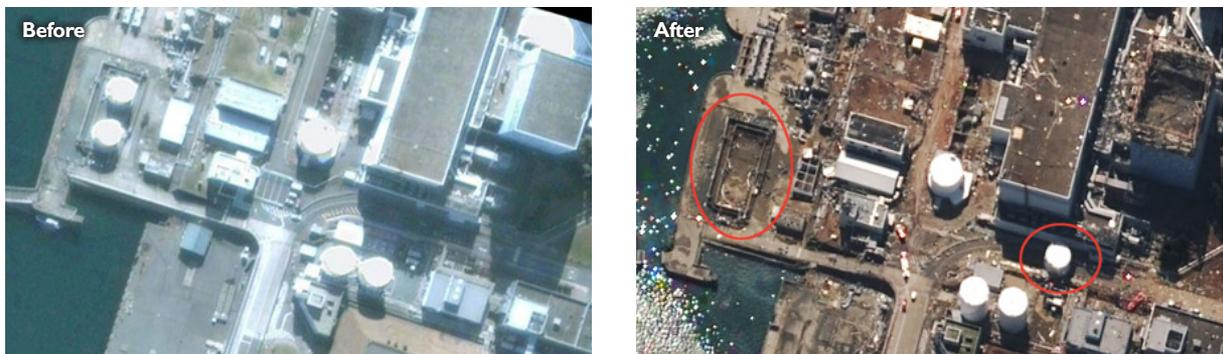
**Fig. 6** - I grandi serbatoi di gasolio, letteralmente strappati dalle loro basi d'impianto e spostati a decine di metri di distanza.
