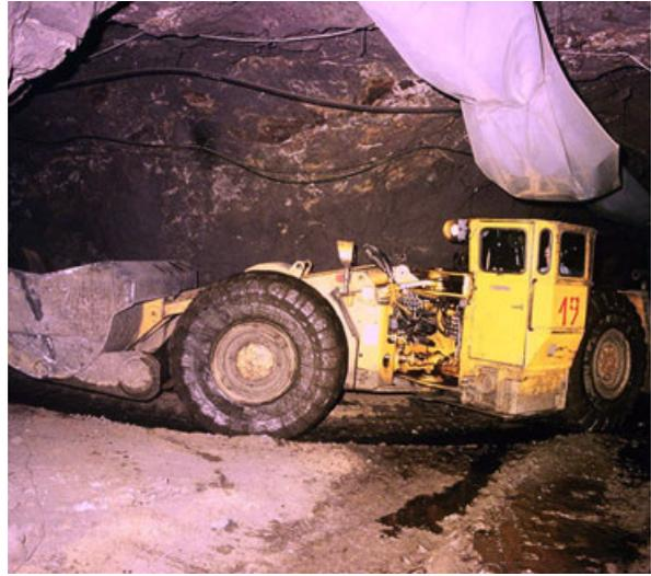
**Fig. 16** - Autopala diesel cabinata con benna da 4-5 m<sup>3</sup> e potenza di kW 204 (Miniera di Campiano. Anni '80)
