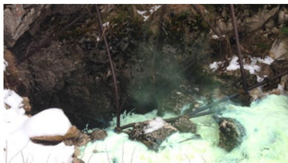
Fig. 3 - Esempio di prova di tracciamento con immissione in inghiottitoio carsico
