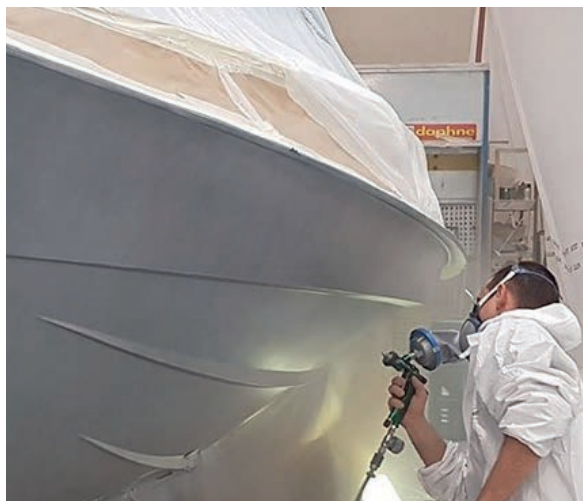
Fig. 2 - Verniciatura di uno scafo con pistola a spruzzo sotto tensostruttura (capanna di verniciatura).
